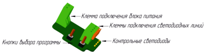
Рис.1 Назначение органов управления и индикации
